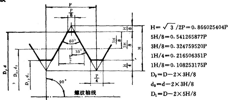
D—内螺纹大径；d—外螺纹大径；D<sub>2</sub>—内螺纹中径；d<sub>2</sub>—外螺纹中径；
